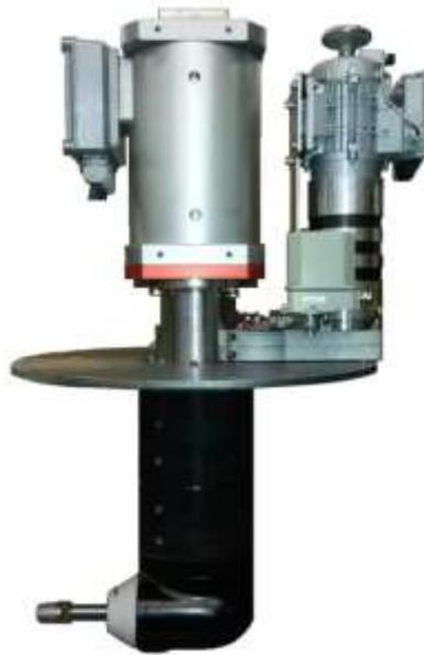
Abbildung: Sail-Drive elektrisch drehbar
